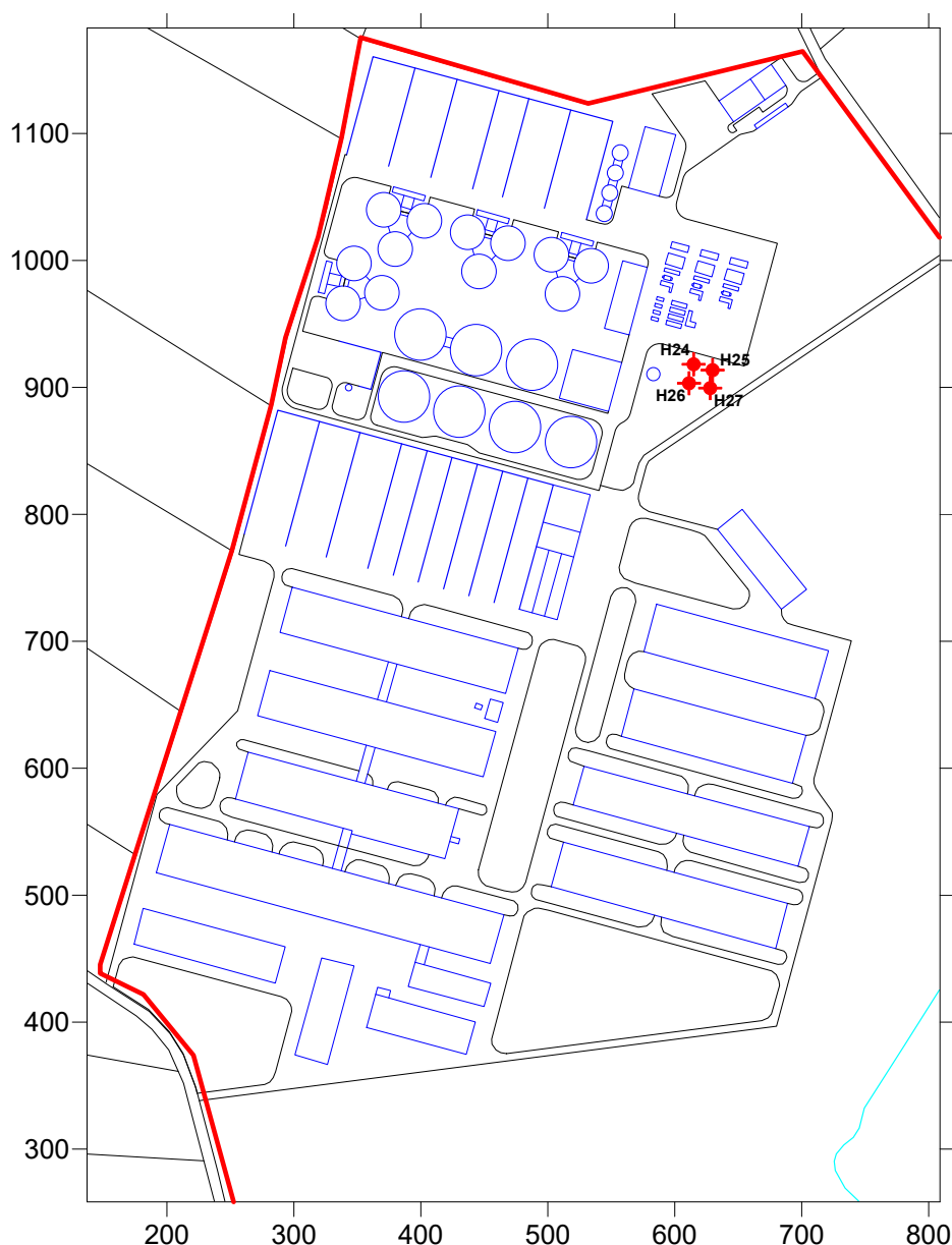
Rysunek 37. Biometanownia – pochodnie gazowe – lokalizacja punktowych, wszechkierunkowych źródeł hałasu H24÷H27
