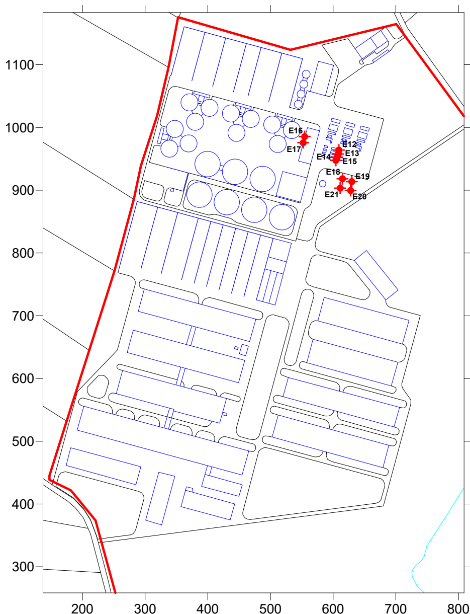
Rysunek 9. Biometanownia – moduły kogeneracyjne, kotły na biogaz i pochodnie gazowe – lokalizacja emitorów punktowych (E12÷E21)
