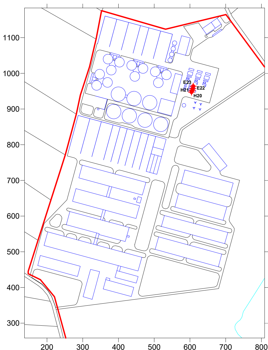
Rysunek 36. Biometanownia – wyloty spalin silników gazowych – lokalizacja punktowych, wszechkierunkowych źródeł hałasu H20÷H23
