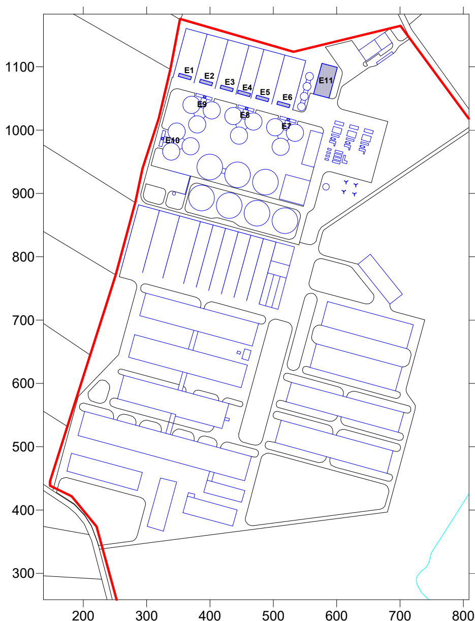
Rysunek 8. Biometanownia – magazynowanie i dozowanie substratów – lokalizacja emitorów powierzchniowych (E1÷E11)
